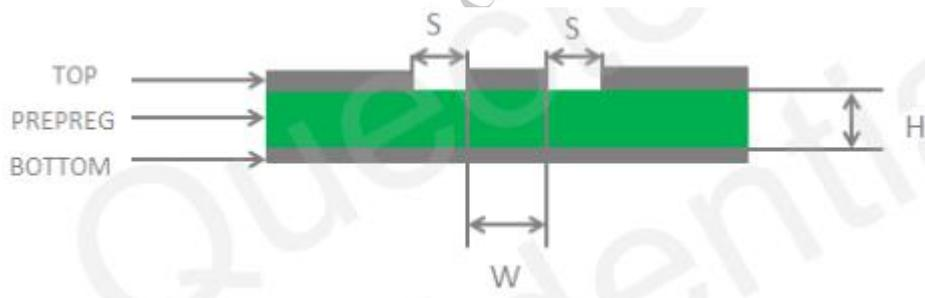
图 33: 两层 PCB 板共面波导结构
