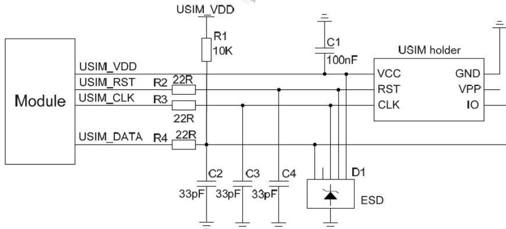
图 18: 6-pin USIM 卡座参考电路图
