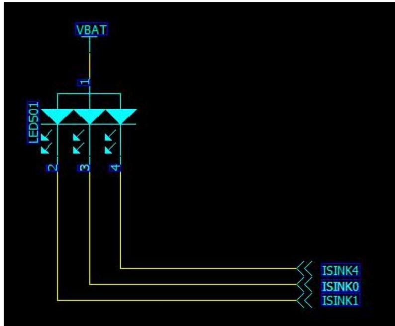
图 32 LED 指示接口参考电路
