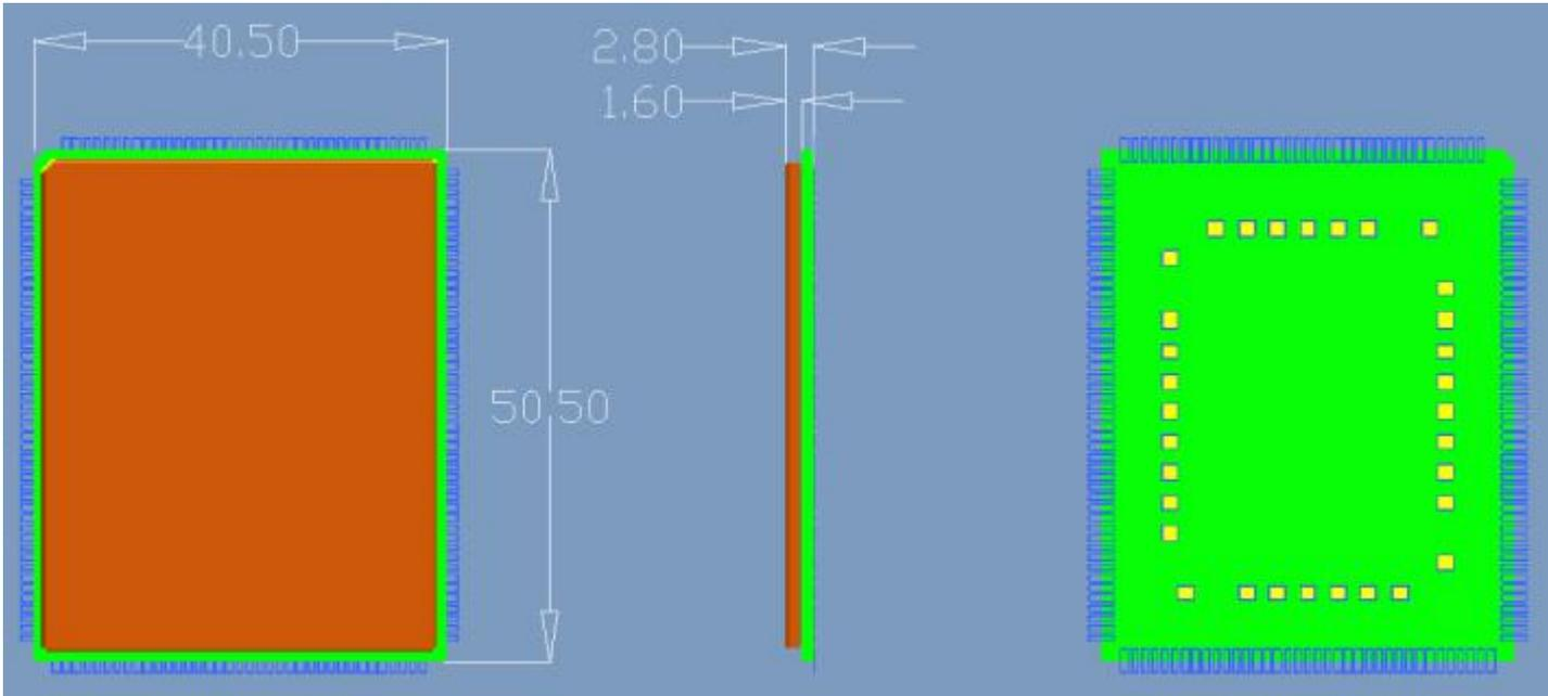
图 38: XY6763 俯视图及侧视图尺寸
