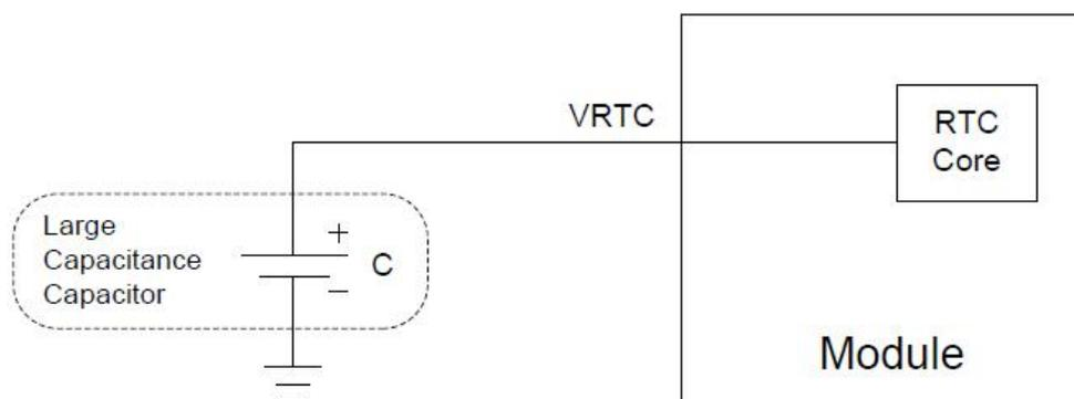
图 11: 电容给 RTC 供电
