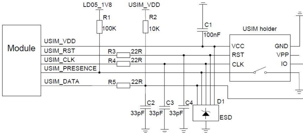
图 17: 8-pin USIM 卡座参考电路图
