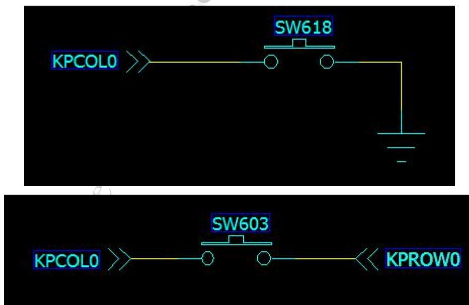
图 30 紧急下载接口参考电路
