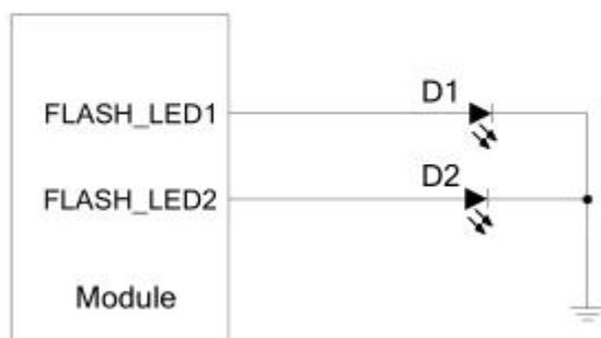
图 31 Flash light 接口参考电路
