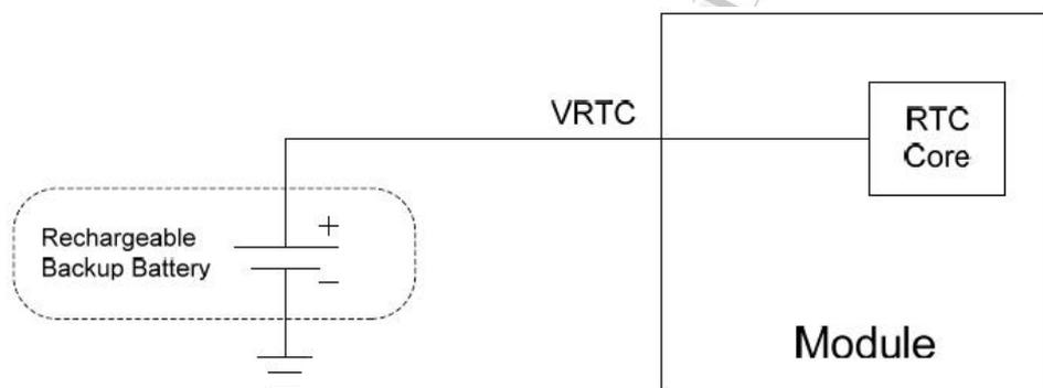
图 10: 可充电纽扣电池给 RTC 供电
