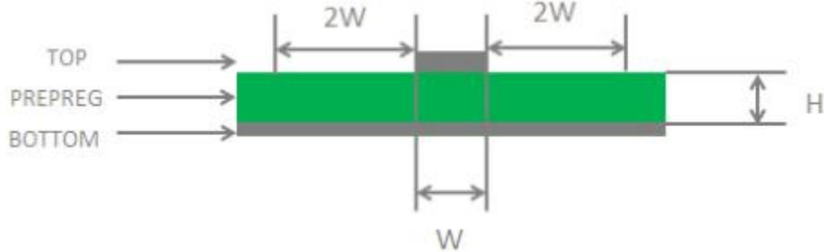
图 32: 两层 PCB 板微带线结构
