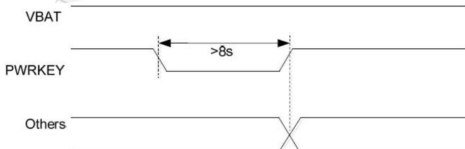
图 9：关机时序图
