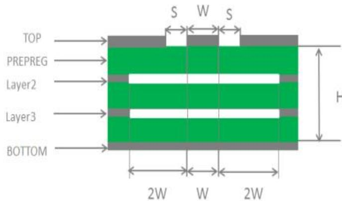
图 34：四层 PCB 板共面波导结构（参考地为第四层）
