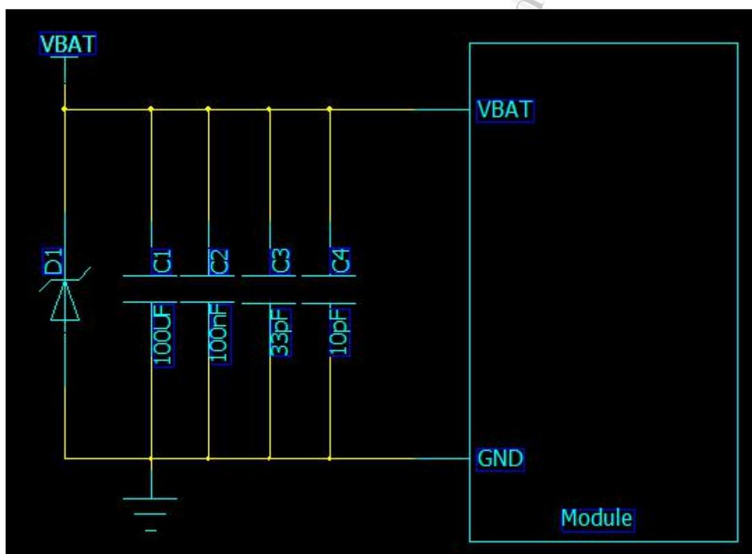
图 4：VBAT 输入参考电路
