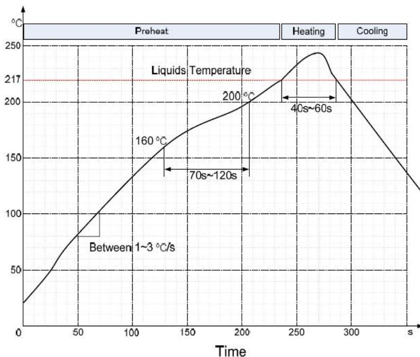
图 43: 回流焊温度曲线
