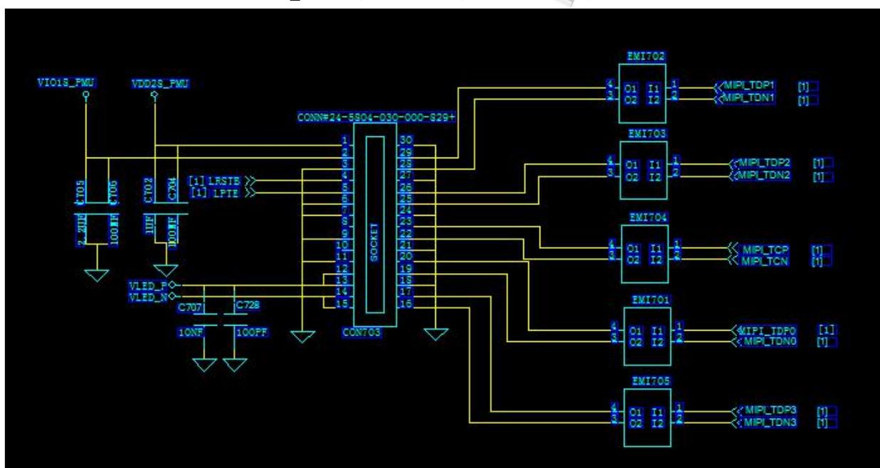
图 21: LCM 电路
